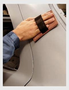
**WEICHE MATERIALIEN.** Abranet ist ideal zum Schleifen von weichen Materialien, da die spezielle Netzstruktur das Schleifmittel vor schnellem / vorzeitigem Zusetzen bewahrt.
