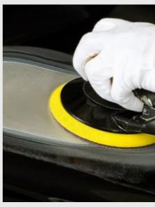
**ALUMINIUM.** Metalle wie Aluminium, werden immer mehr in modernen Autos verarbeitet. Das Schleifen dieser Materialien erfordert eine effektive Staubabsaugung sowohl aus produktionstechnischen, als auch aus gesundheitlichen Gründen.
