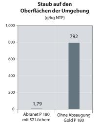
**TESTSIEGER.** Labortests zeigen, dass Abranet das Staubproblem gelöst hat. Die Staubmenge beim maschinellen Schleifen mit Abranet ist 6 900-mal geringer im Vergleich zu traditionellen Schleifmitteln ohne Staubabsaugung. Beim Vergleich mit einer traditionellen 6-Loch Schleifscheibe mit Staubabsaugung konnte ermittelt werden, dass die Staubkonzentration von Abranet maximal 0,15 mg/m³ beträgt, während der entsprechende Wert bei der traditionellen Schleifscheibe 1,6 mg/m³ ist.
